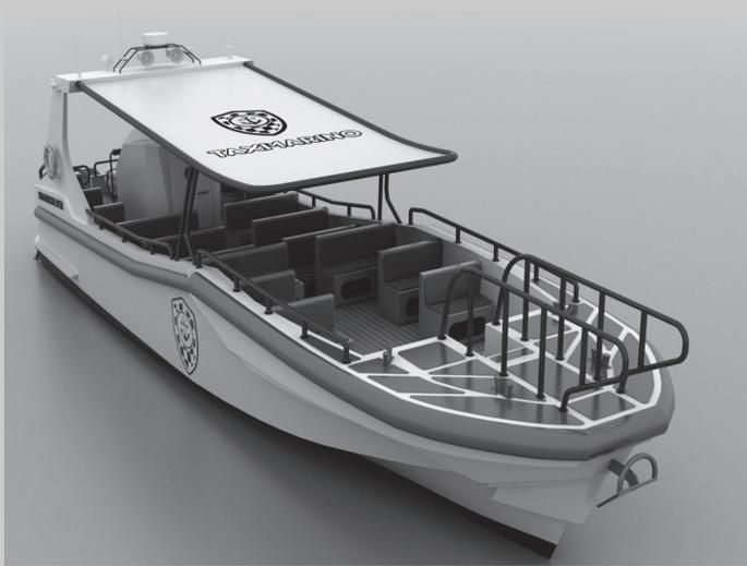
La embarcación tiene una eslora de 13.8m y capacidad para 38 personas y 2 tripulantes. La potencia máxima instable es de 2x 400hp permitiendo velocidades de 30kn a plena carga.
