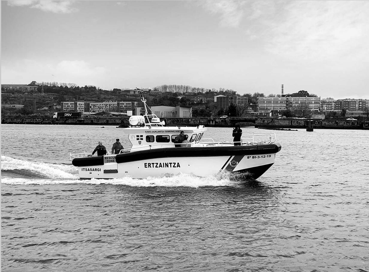
Esta embarcación de 11 metros de eslora está diseñada expresamente para la ERTZAINTZA para cumplir las labores más exigentes con mares agitados. Dispone de una superficie útil de bañera en popa de más de 9m<sup>2</sup> con fácil acceso al mar para el rescate de personas y completamente autovaciante.
