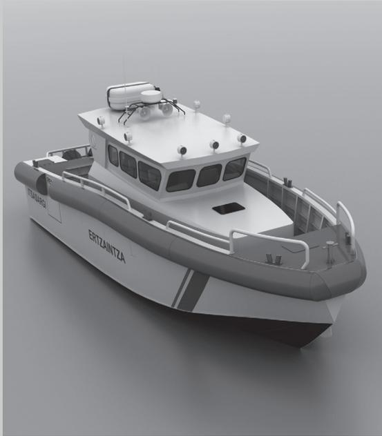
La doble motorización MERCURY de 300hp cada uno, impulsan la embarcación a 34kn a velocidad máxima a plena carga con una elevada autonomía gracias a sus 1200 litros de combustible.
