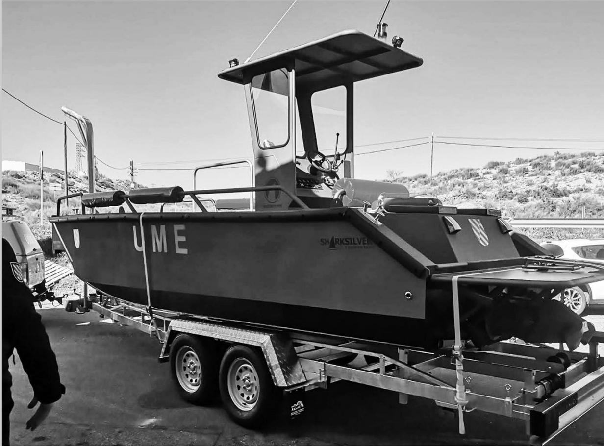
Embarcaciones de trabajo para la UNIDAD MILITAR DE EMERGENCIA dotadas con medio de desembarco rápido y amplia cubierta de trabajo. La embarcación es propulsada por un motor de 300hp permitiendo velocidades cercanas a los 40kn plena carga.
